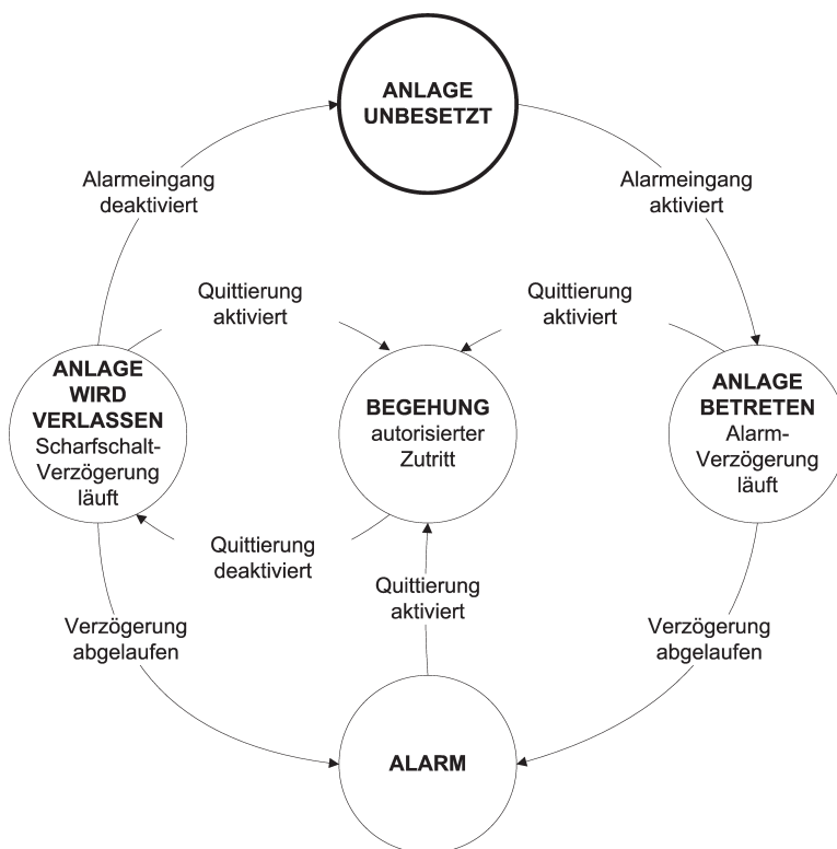
Zustandsdiagramm der Objektschutzfunktion
